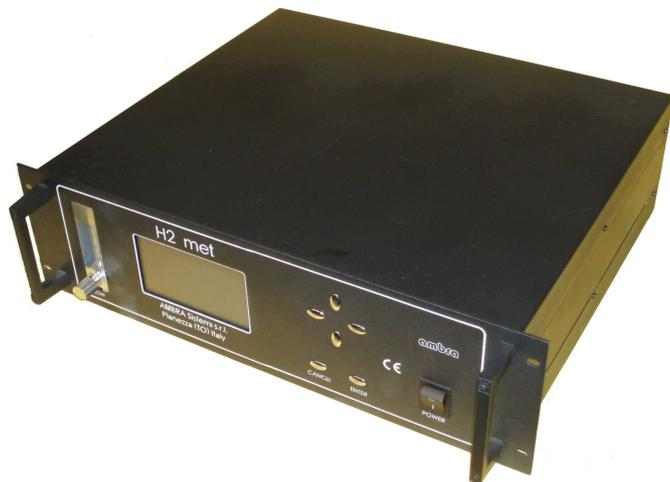
**Analizzatore di idrogeno basato su tecnologia con sensore a conducibilità termica**
